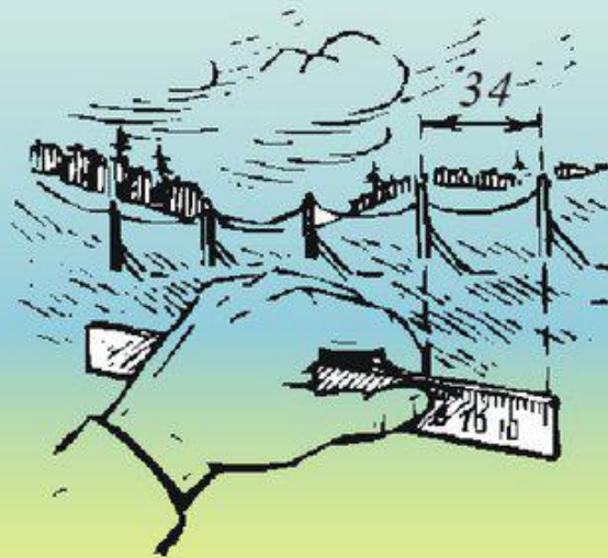
Рис. 2. Вимірювання вертикального і горизонтального кутів за допомогою лінійки
